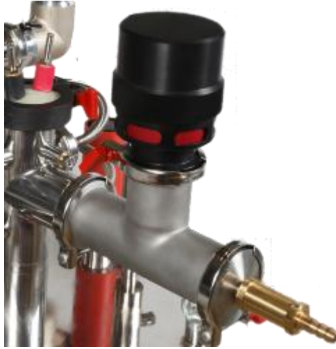
图 3.6: Oxford Instruments 低温恒温器的液氮容器装有失超泄压阀和止回阀。
