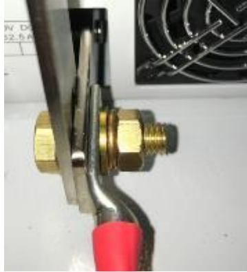
图 5.1：正确连接磁体电流会接通电源。磁体电流引线上的压接接头与电源母线直接接触，而垫圈、弹簧垫圈和螺母在相反侧。
