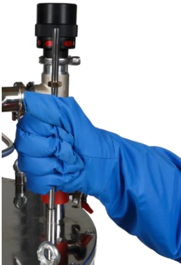
图 3.8：使用金属探针检查液氮容器是否堵塞。
